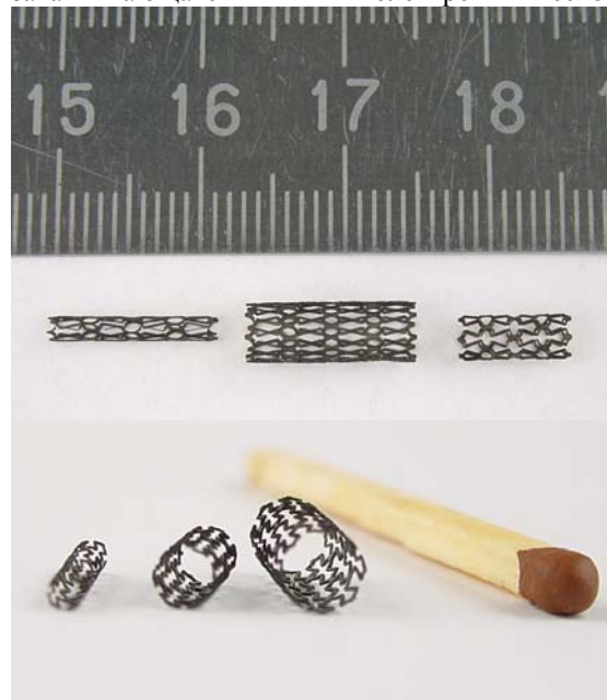
Рис. 3: Фотографии стентов диаметром 1,6, 3 и 4 мм с биосовместимым (алмазоподобный углерод) покрытием
